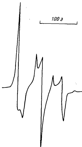
Рис. 1. Спектр ЭПР двуокиси азота при 77° К.
